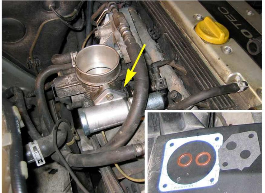
Den Leerlaufsteller herausnehmen und den **Magnetschalter** (im Bild rechts) abschrauben. Dessen Stößel säubern und gleich einen Tropfen (Nähmaschinen- oder Fahrrad-) Öl in die Vertiefung geben.
