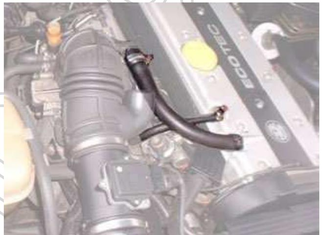
An der **Drosselklappe** sieht man die Verschmutzungen der Öldämpfe (Blow-By-Gase) aus dem dickeren der beiden Kurbelgehäuse-Entlüftungsschläuche.
