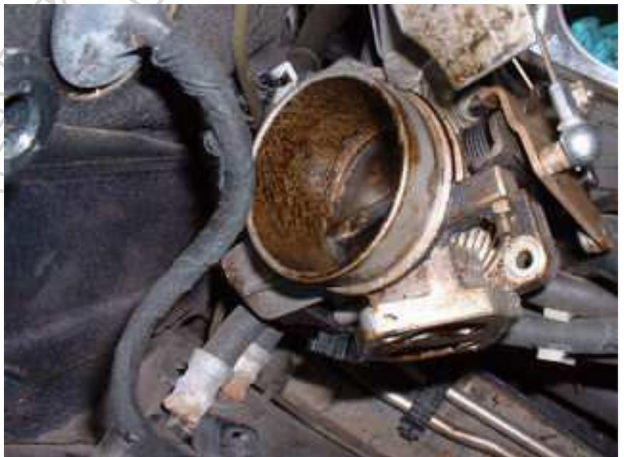
Schließlich (nach Entfernung der Lappen) alles wieder zusammenbauen und dabei möglichst **neue** Dichtungen verwenden. Auf den korrekten Sitz der Leerlaufsteller-Dichtung achten (siehe weiter oben). Die beiden Inbusschrauben ja nicht zu stark anziehen (Guss).
