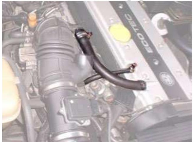
Nun kann man als Schnellmaßnahme versuchen, den verstopften Schlauch und die Hohlschraube wieder durchlässig zu machen. Dazu könnte man z.B. mit einem entsprechend langen Draht oder auch einem großen stabilen Kabelbinder im Schlauch "puhlen", ob so griesartige Ölkohle zum Vorschein kommt. Durch Einspritzen von z.B. Bremsenreinigerspray in den Schlauch, mit der eigenen Puste oder gar Druckluft und weiteres "puhlen" kann man versuchen, die Leitung wieder frei zu bekommen.
