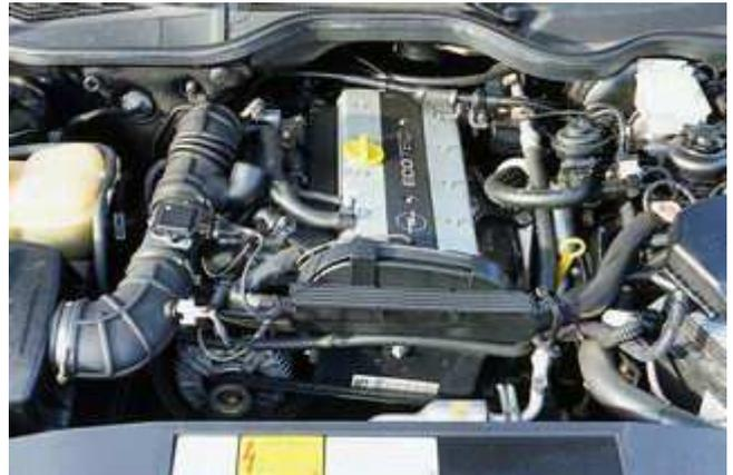
Die **Schlauchklemmen** des dickeren der beiden Kurbelgehäuse-Entlüftungsschläuche an dessen beiden Enden durch Zusammendrücken (z.B. mit einer Wasserpumpenzange) öffnen - bzw. Schraubschellen aufschrauben - und den Schlauch zum Säubern oder Auswechseln abnehmen.
