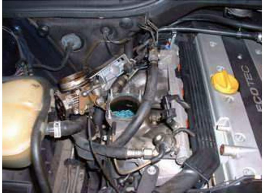
In der nun offenen Ansaugkammer kann man auf der zum Motorblock hin zeigenden Seite die **Hohlschraube** sehen (meine Nadel steckt darin), in die der dünnere der beiden Kurbelgehäuse-Entlüftungsschläuche mündet (hier bereits entfernt).
