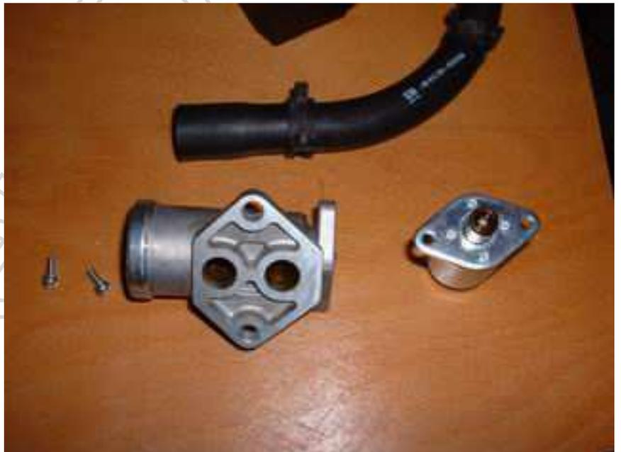
Die Funktionstüchtigkeit des Magnetschalters kann durch abwechselndes Anlegen von 6V an den Kontakten geprüft werden.
