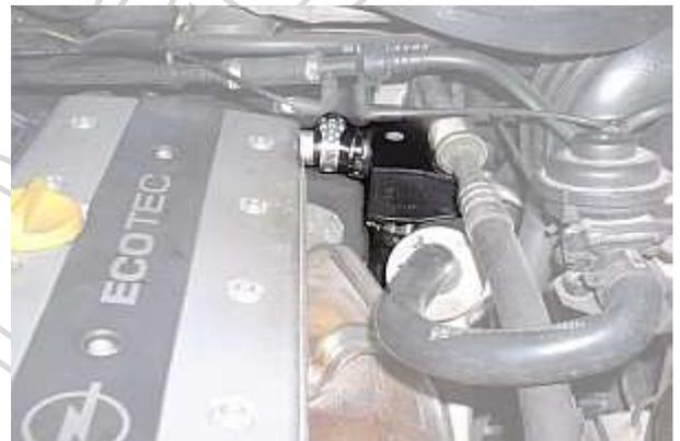
Der Ölabscheider wird in dem Schlauch montiert, der von unten vom Kurbelgehäuse und der Ölwanne kommend nach oben in den Ventildeckel führt. Dieser Ölabscheider soll die ganze Ölverschmutzung überhaupt verhindern bzw. zumindest verzögern.
