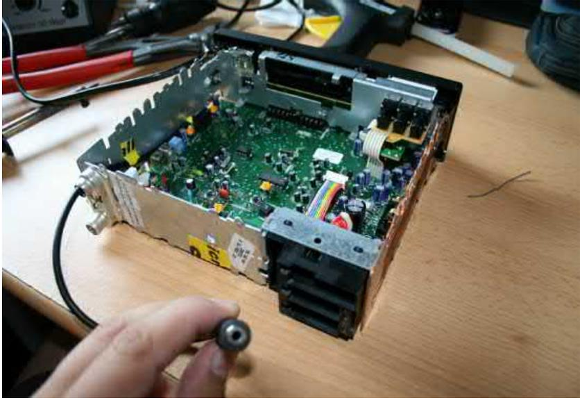
Kabel mit Klinkenbuchse durch vorbereitete Bohrung führen und verlegen/fixieren.
