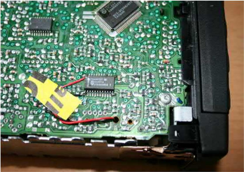
Kabel durch eine Bohrung auf die Rückseite der Platine führen. Dort dann nach Anschlussplan an den Pins 1 – OUTA und 24 – OUTB verlöten. Die Masse wird weggelassen.
