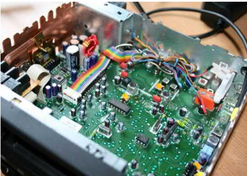
Kabelbaum beibehalten, Schalter überbrücken und isolieren. Einfach mal probieren, das Radio muss sich noch auf „Cas 1“ umschalten lassen.
