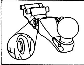
3.3 Zum Verrasten des grün gekennzeichneten Bolzens muß dieser gedrückt werden, bei gleichzeitigem Drehen des Handrades im Uhrzeigersinn nach vorne (siehe Pfeilrichtung Handrad).
