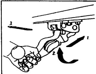
3.7 Kugelstange schräg nach vorne oben in das Gehäuse bis zum Anschlag einschieben, Kugelstange nach oben bis an den Anschlag schwenken und unterhalb der Kugel nach hinten oben ziehen. Kugelstange verriegelt hörbar automatisch.
