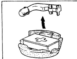
3.1.1 **Kugelstange aus der Fahrzeugablage entnehmen (Limousine).**
