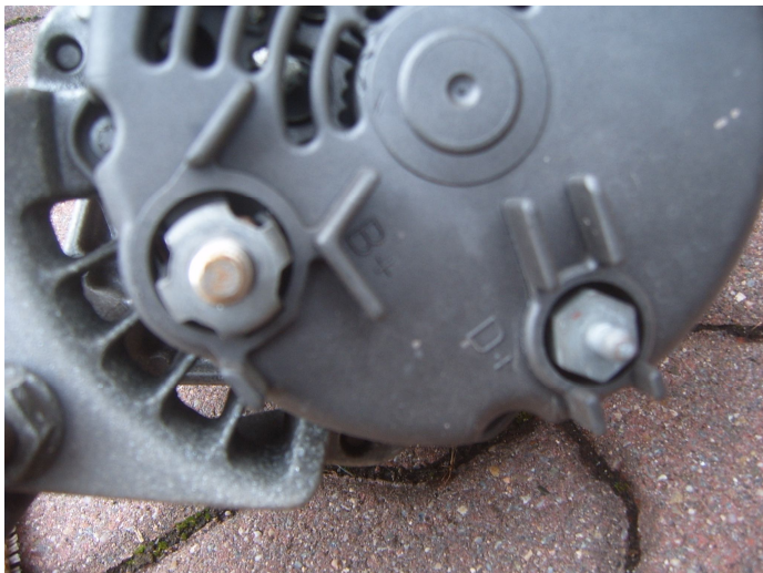
Bild 5: Die Kabelanschlüsse der Lichtmaschine
