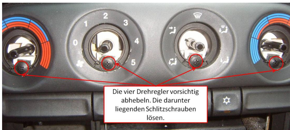
Bild 4: Die 4 Drehregler ausbauen
