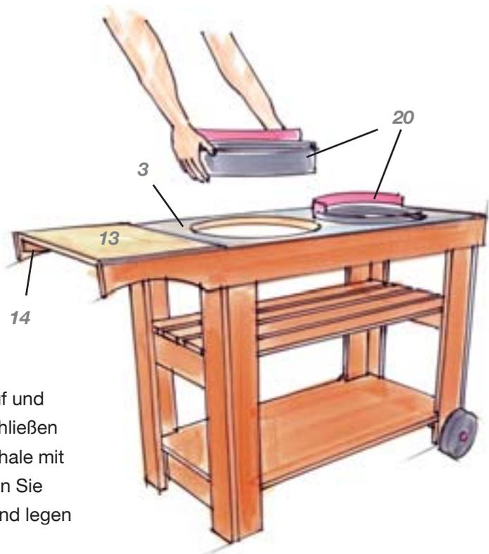
**16** Zum Schluss legen Sie das Glattblech (3) auf und bauen die Grills (20) ohne Beine zusammen. Verschließen Sie alle nicht benötigten Öffnungen in der Feuerschale mit feuerbeständigem Ofen- und Kesselkitt (26). Setzen Sie dann die Grills in die Öffnungen der Platte (3) ein und legen das Schneidbrett (13) auf die Leisten (14) auf.
