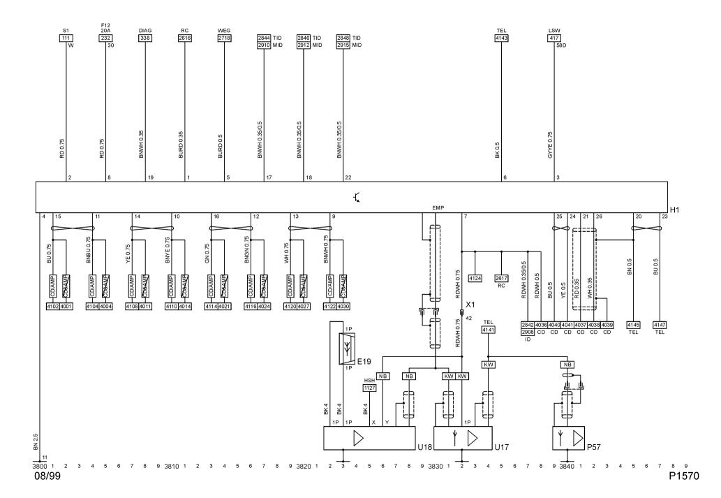
**Stromkreis** H73 Globales Positions System Einheit Carphone 3900 - 3949 P57 Antenne U17 Verstärker - Antenne, Dach U18 Verstärker - Antenne, Massepunkte Heckscheibe X1 Instrumententafel & Karosserie Halterung, Lenksäule X7 Instrumententafel & Empfänger, hinten
